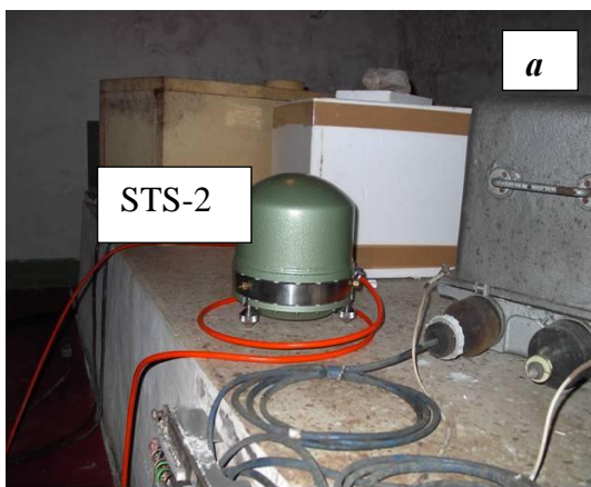
Рисунок 2.4 – Расположение сейсмоприемника на постаменте шахты ГФО "Михнево" (а) и геометрия трехкомпонентного сейсмометра STS-2 (б).
