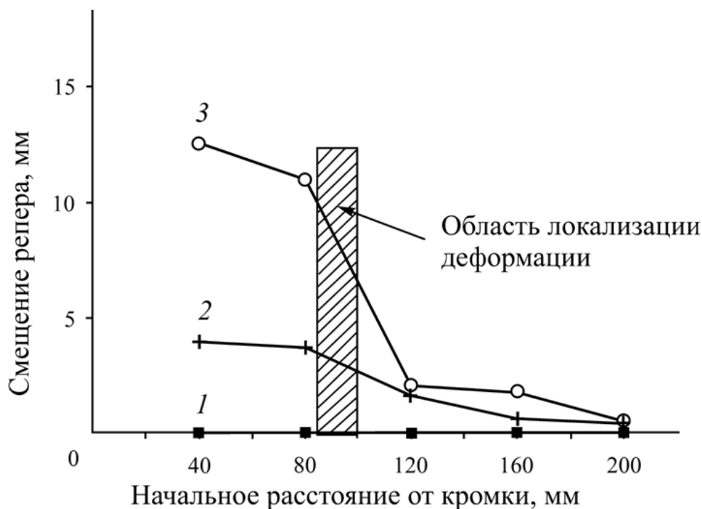
Рисунок 3.10 – Смещение реперной линии на разных расстояниях от кромки склона при многократных воздействиях после 6 (1), 7 (2) и 8 ударов (3)
