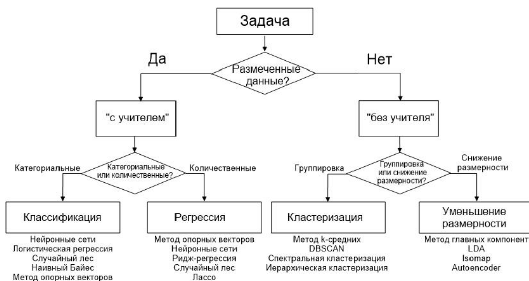
Рисунок 1.8 – Блок-схема выбора подходящего алгоритма МО для имеющегося типа данных и поставленной задачи (Kong, 2018)
