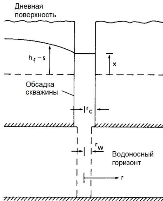
Рисунок 1.5 – Схема скважины, пробуренной в напорный водоносный горизонт в соответствии с моделью (Hsieh et al., 1987) ( h_f (м) - вариации напора, s (м) - снижение; r_w (м) – радиус рабочей части скважины; r_c (м) – внутренний радиус обсадной колонны скважины)
