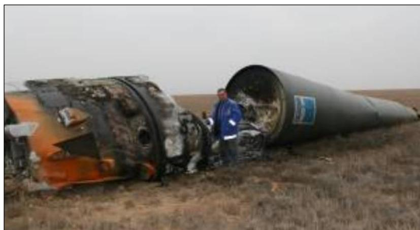
Рисунок 5.9. Фрагмент двигательной установки 1-й ступени РН «Союз», обнаруженный по результатам инфразвуковой локации
