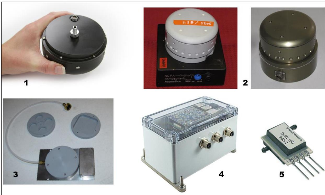
Рисунок 2.3. Современные микробарографы.
