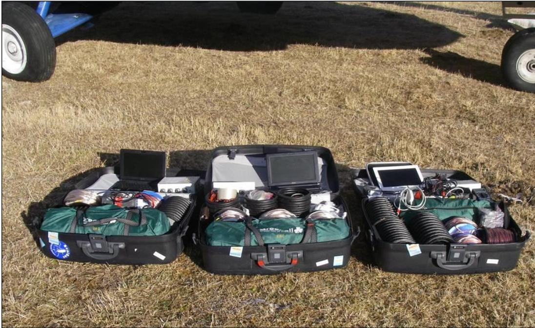
Рисунок 2.14. Общий вид 3 комплектов мобильных инфразвуковых станций, подготовленных к транспортировке
