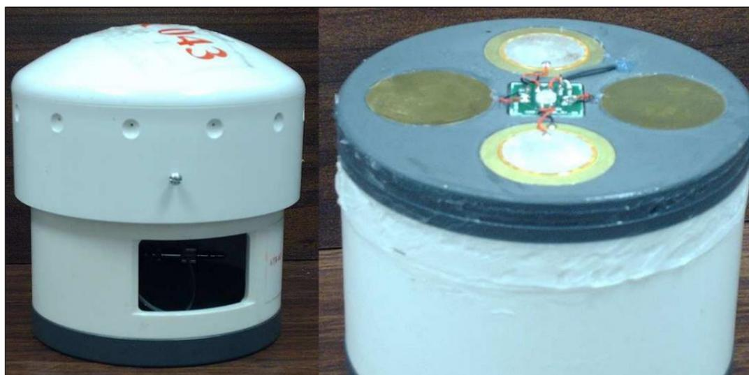
Рисунок 2.9. Дифференциальный пьезокристаллический микробарограф, разработанный в Acoustic Technology Research (DeWolf, 2006)
