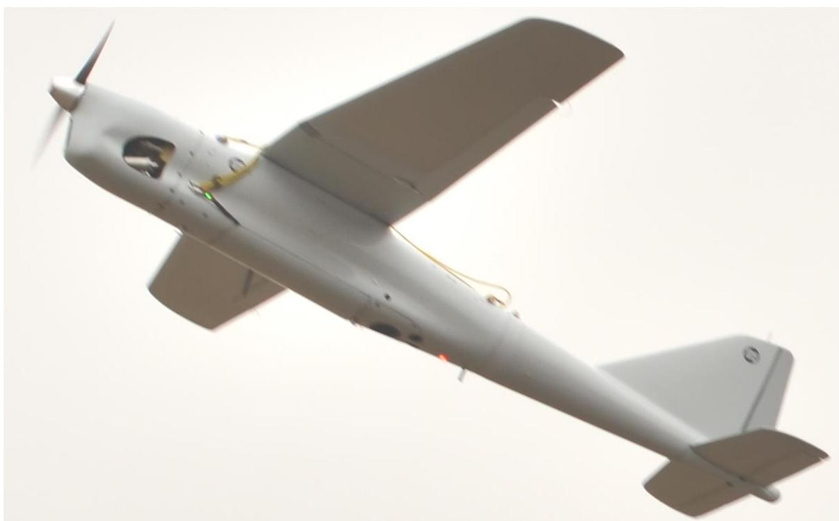
Рисунок 2.28. Внешний вид БПЛА «Орлан-10»
