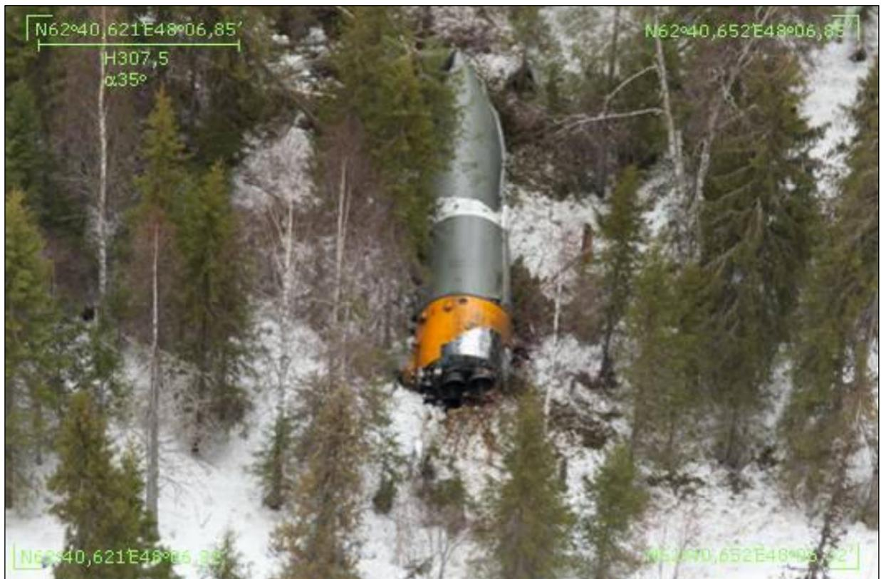
Рисунок 5.23. – Кадр фотодокументирования места падения фрагмента РН «Союз-2» (23 марта 2014 г.). Использован фотомодуль «Canon 5D Mark-II». Высота наблюдения 307.5 м. Угол обзора 35°
