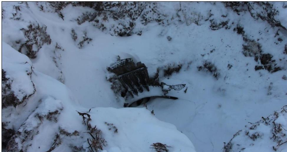
Рисунок 5.39. Фрагмент двигательной установки 1-й ступени РН «Ангара-А5.1Л», обнаруженный после проведения пуска по результатам инфразвуковой локации
