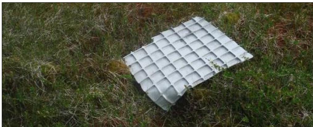
Рисунок 5.39. Фрагмент обечайки топливного бака 1-й ступени РН «Ангара-А5.1Л», обнаруженный в зоне «группа фрагментов 2» (см.рис.5.37)
