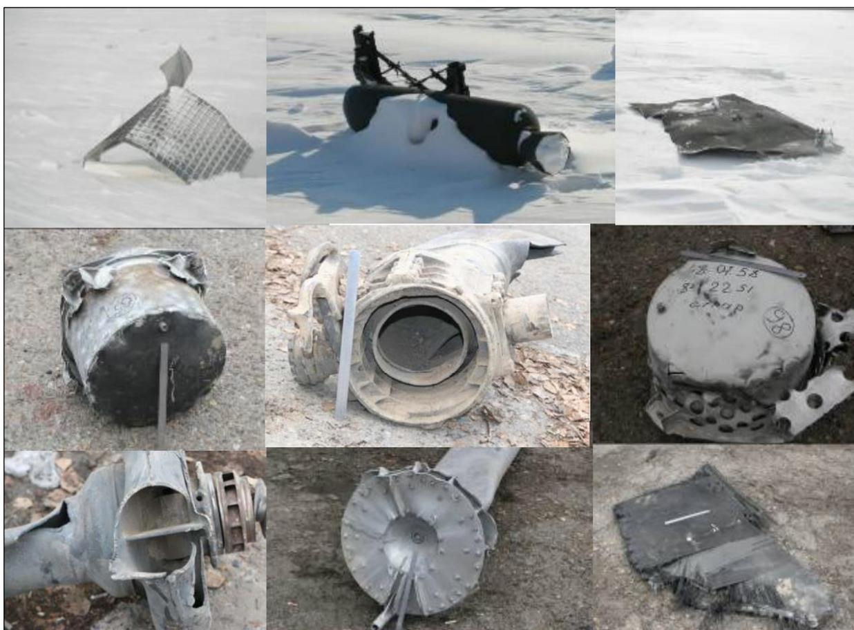
Рисунок 5.14. Фрагменты створок головного обтекателя и деталей двигательных установок, обнаруженных в РП №327
