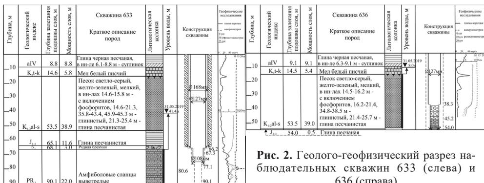
**Рис. 2.** Геолого-геофизический разрез наблюдательных скважин 633 (слева) и 636 (справа)
