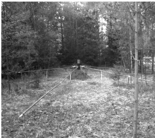
Рис. 1. Общий вид пункта акустической регистрации с шумоподавляющим фильтром
