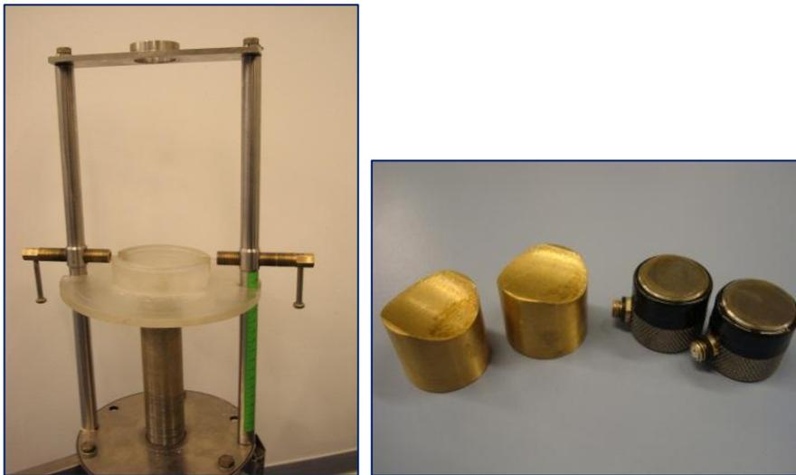
**Рис. 64. Ручная система позиционирования и датчики Olympus V103-RM для ультразвукового профилирования образцов горных пород.**
