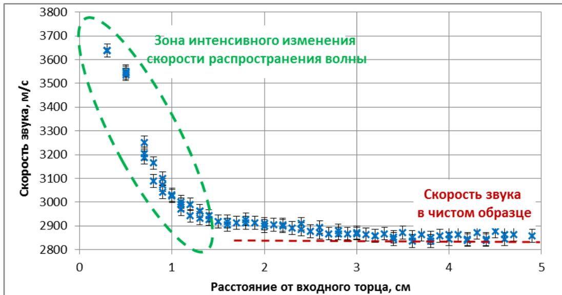
**Рис. 71. Профиль скорости распространения  $P$ -волны для образца Bentheimer (BT15).**
