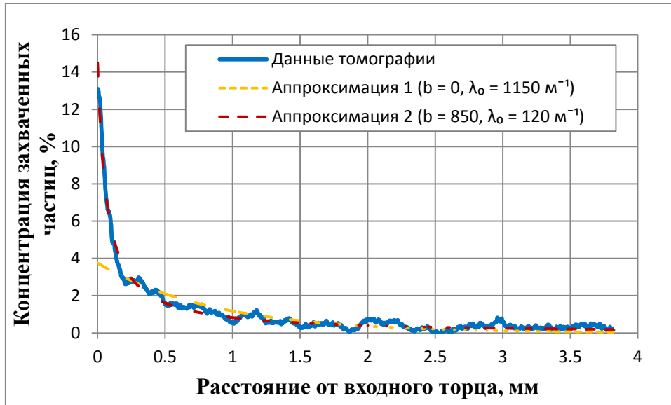
Рис. 10. Профиль захваченных частиц карбида кремния в образце песчаника Bentheimer и аппроксимации профиля с помощью выражений (16) и (20).
