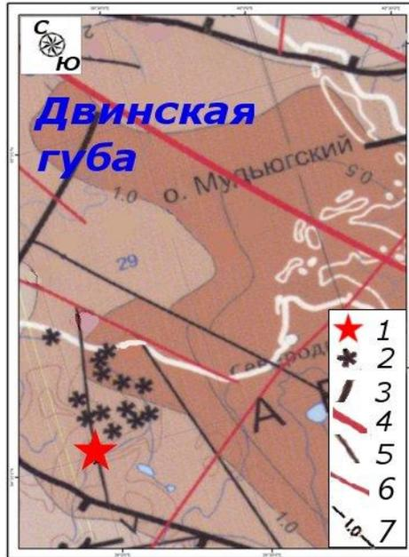
1 – исследуемая трубка взрыва, 2 – трубки взрыва, 3 – разломы, ограничивающие крупные структуры земной коры, 4 – разломы активные на неотектоническом этапе, 5 – прочие разломы, 6 – изогипсы поверхности кристаллического фундамента, 7 – изолинии фундамента
