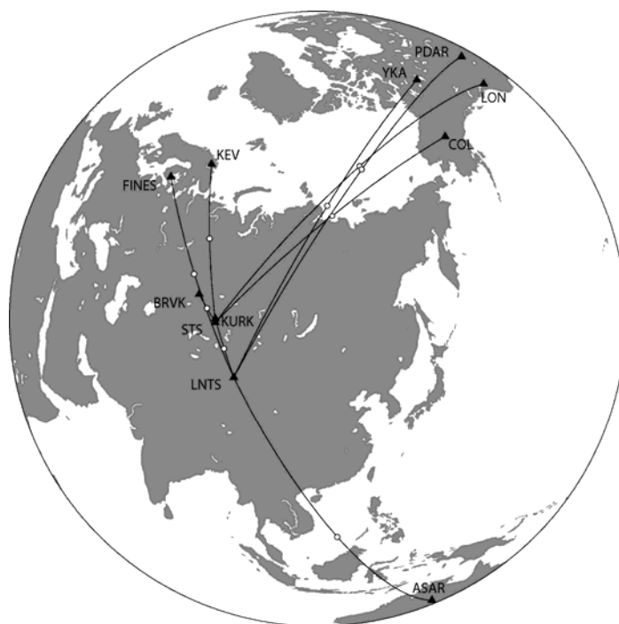
Рис. 4-1. Карта взаимного расположения взрывов и мест регистрации с дугами большого круга. STS – Семипалатинский полигон, LNTS – полигон Лобнор, трёхкомпонентные станции BRVK, KEV, COL, LON. Сейсмические группы: ASAR, FINES, KURK, PDAR, YKA. Белые точки соответствуют проекциям точек отражения PKiKP от внутреннего ядра Земли на дневную поверхность.
