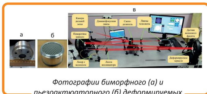
Фотографии биморфного (а) и пьезоактюаторного (б) деформируемых зеркал и быстрой адаптивной оптической системы (в)
