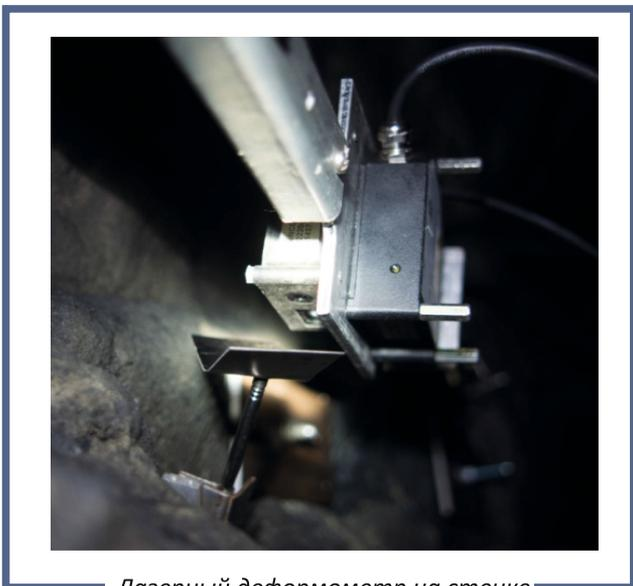
Лазерный деформометр на стенке горного массива
